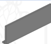
Exemplo: Muro de contenção
