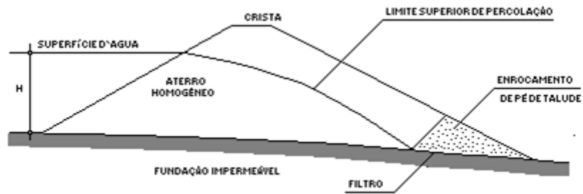
DRENO DE PÉ DE TALUDE
